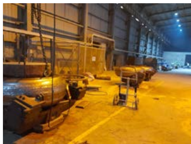
Les trois galets du broyeur charbon démontés et ramenés aux ateliers pour révision
